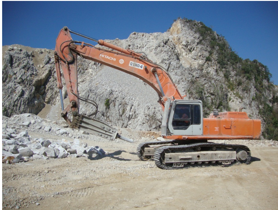
รูปที่ 2-9: รถแบ็คโฮรัดหัวกระแทกไฮดรอลิก
